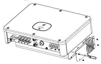
fig12.1 Remove the fan
