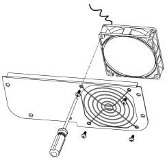
fig12.2 Remove the fan
